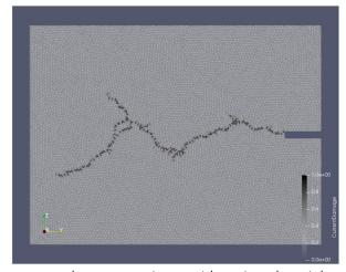
relâchée. Souvent considérée comme élastique, elle recouvre en fait des processus complexes avec notamment la rupture de certains des liens créés au cours de la phase de compression. Ces ruptures peuvent même provoquer l'apparition de fissures macroscopiques comme le décalottage ou le laminage, qui sont rédhibitoires au niveau de la production [1].
